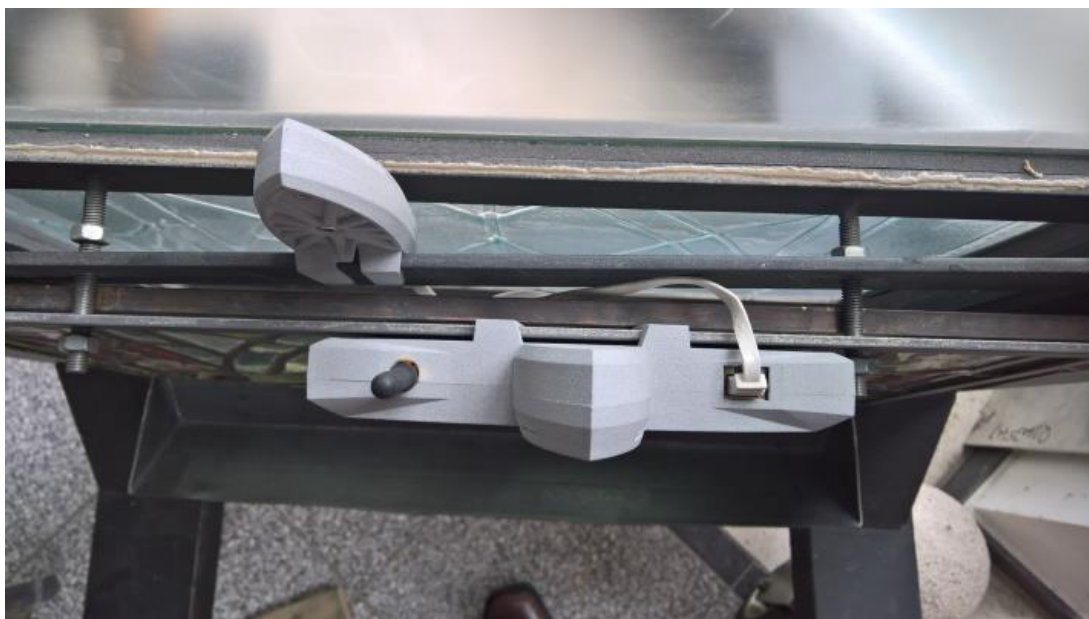
Abb. 3. Custos Aeris für die Dauerüberwachung der thermodynamischen Zustände von Original- und Schutzverglasung.
